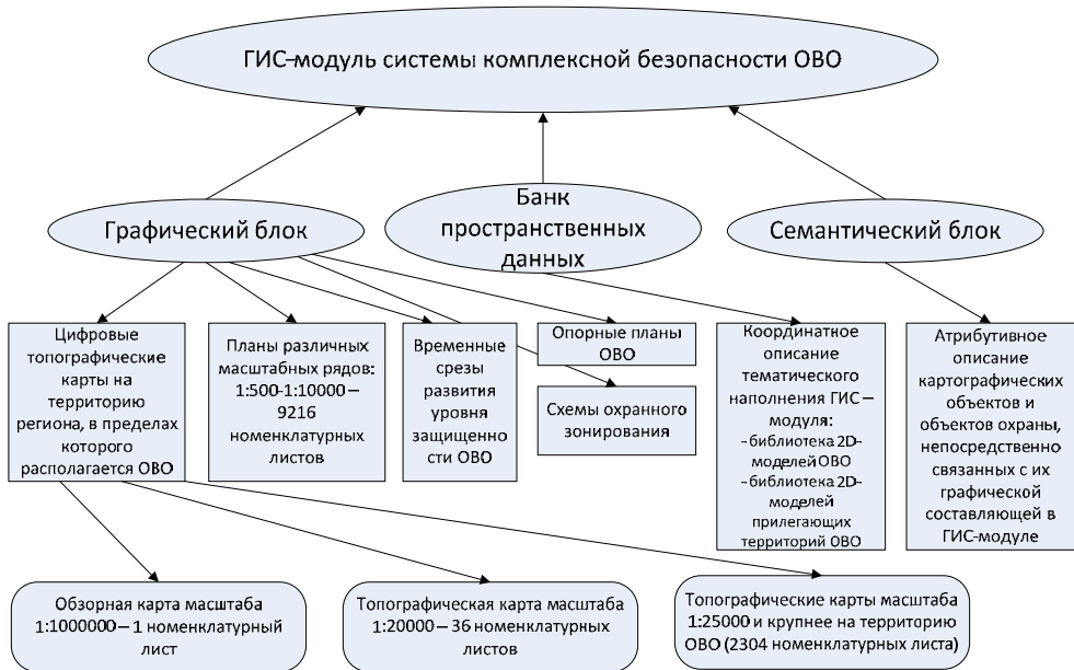
Рис. 2. Состав ГИС-модуля системы безопасности ОВО
